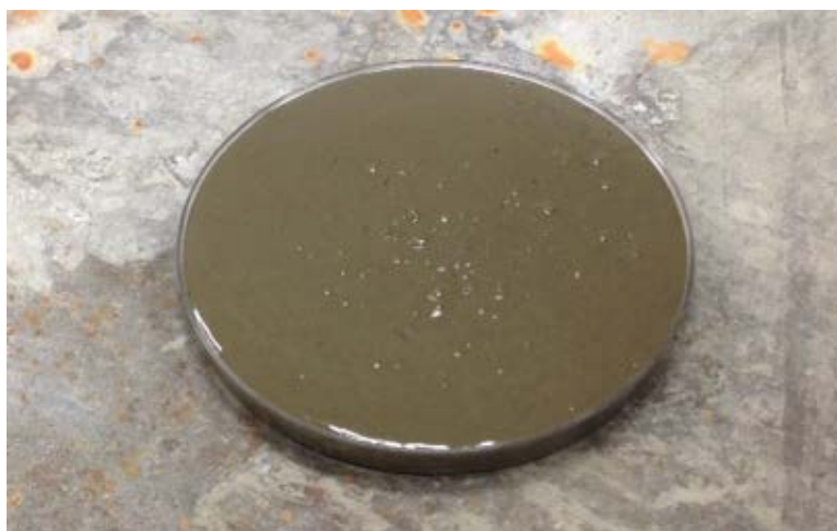
Fig. 3 Nygjutet provobjekt av pasta, för vidare härdning samt TGA-analys
